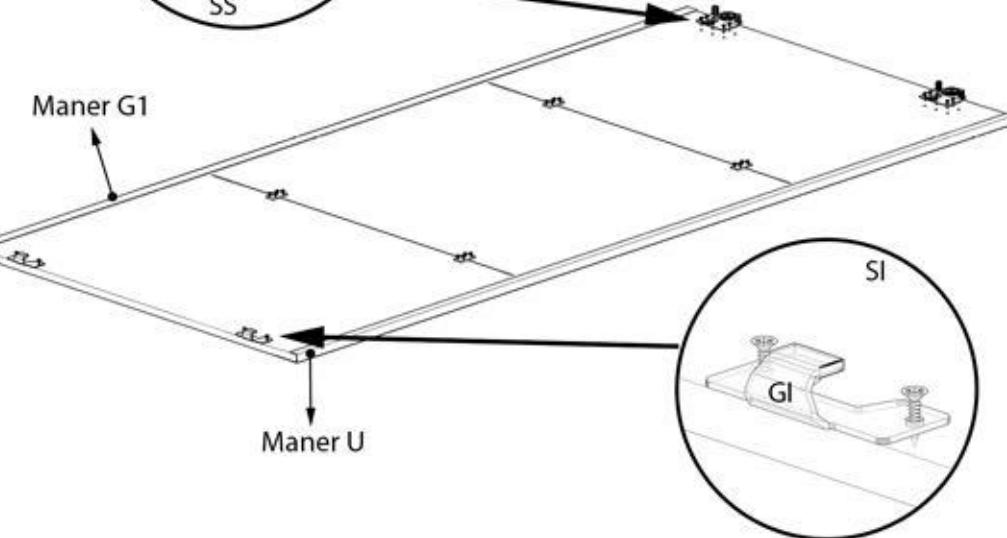
Rolele glisante interioare (RGI) se fixeaza pe segmentul superior(SS) cu ajutorul suruburilor de 3,5x16(S3).
