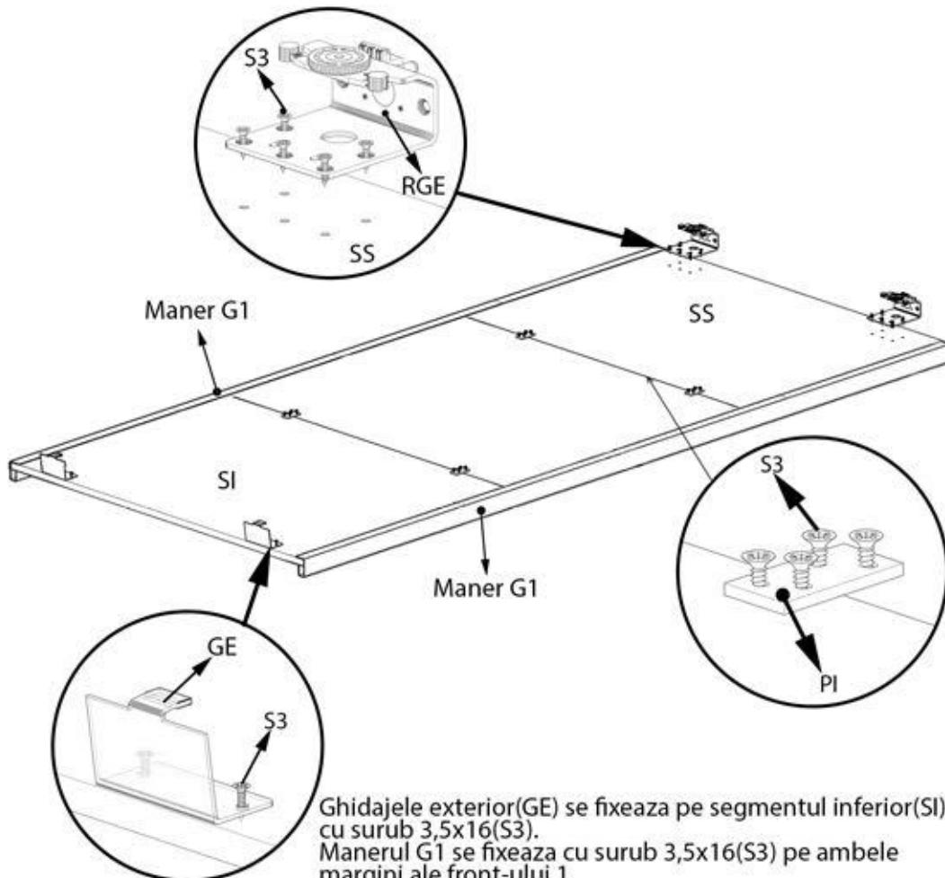
Ghidajele exterior(GE) se fixeaza pe segmentul inferior(SI) cu surub 3,5x16(S3).
