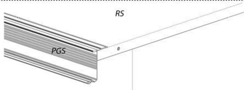
Dupa ce profilul de glisare inferior(PGI) si superior(PGS) au fost fixate, se aseaza fronturile pe dulap. Acestea se vor aseza, mai intai, cu ghidajul din partea de jos a frontului, in PGI, iar apoi, rolul de glisare din partea de sus a frontului se aseaza in PGS.
