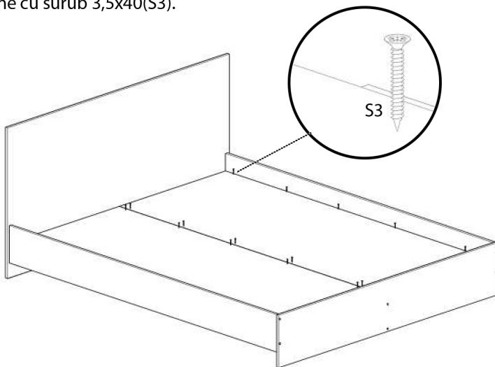
Tapiteria se va prinde cu 10 suruburi 3,5x30 (S2) de pe spatele capatului mare.
