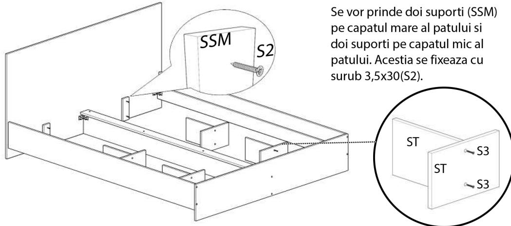
Inainte de a aseza placile pe pat se vor construi patru elemente de tip "T" (ST) si se vor prinde de placile ce sustin salteaua. Dupa ce placile pe care se aseaza salteaua au fost asezate, acestea se vor prinde pe fiecare margine cu surub 3,5x40(S3).
