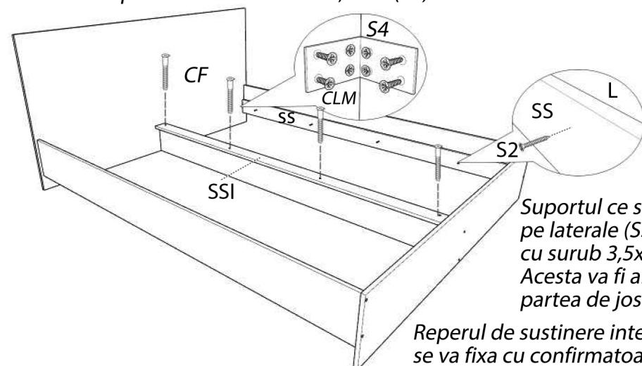
Suporul ce se monteaza pe laterale (SS) se va fixa cu surub 3,5x30(S2). Aceasta va fi aliniat cu partea de jos a lateralei.
