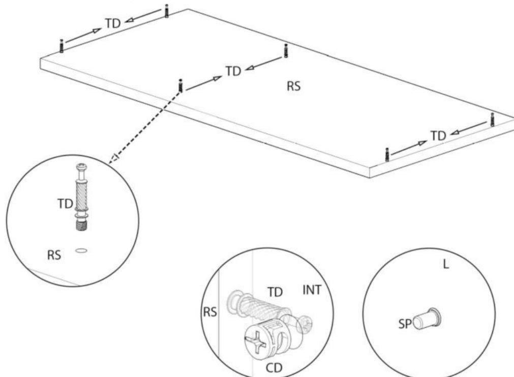
Pentru a prinde corect camele demontabile (CD)
