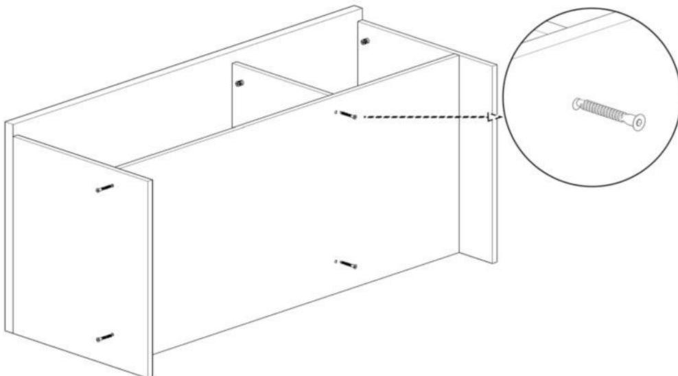
Plinta (P) se aseaza peste laterale (L) si reper inferior (RI). Aceasta se alineaza cu extremitatea de jos a lateralelor (L) si se fixeaza cu coltare (C).
