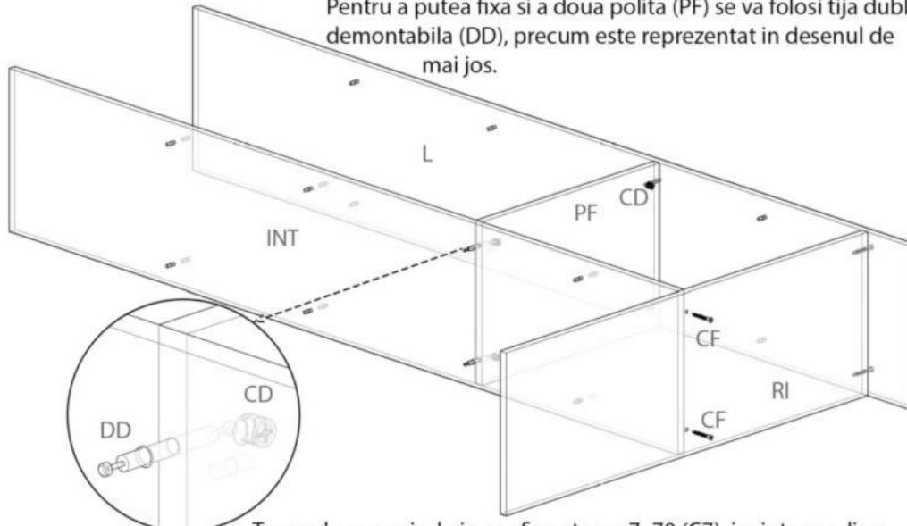
Tavanul se va prinde in confirmatoare 7x70 (C7), iar intermediara se va prinde in confirmatoare 7x50(CF)
