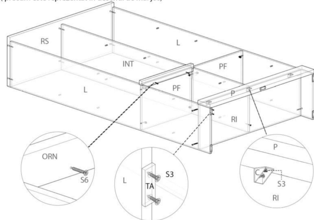
Plinta se va prinde cu C si S3. Precum este reprezentat in desenul de mai sus. Dupa ce plinta a fost montata, se va intoarce dulapul cu cantul in jos si se va incepe montarea spatelui (HDF-ului).
