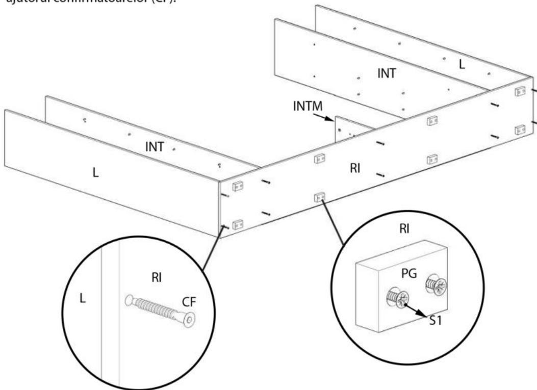
Pe polita fixa (PF) superioara si inferioara (PFS, PFI) se monteaza tije demontabile (TD). Politele fixe se fixeaza cu confirmatoare (CF) de intermediare (INT).
