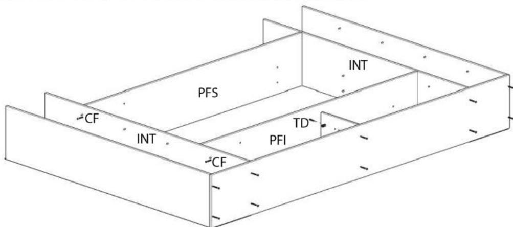
Lateralele mici (LM, LM1) se fixeaza cu confirmatoare (CF) in politele fixe (PFS, PFI). Politele fixe (PFS, PFI) se fixeaza in intermediarele mici (INTM) cu demontabili (TD, CD).
